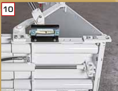
10 Hydraulische Neigungsverstellung der Bohle mit Prozentwasserwaage zur Einstellung und Kontrolle der Einbauneigung
