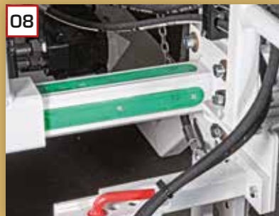
08 Hydraulisch ausfahrbarer Bohlen-träger zur Einbaupositionierung
