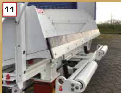
11 Hydraulische Neigungsverstellung der Bunkerklappe
