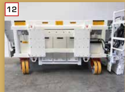
12 Universelle, optionale Adapterplatte zur Vorbereitung für den Anschluss an einen Radlader oder Traktor
