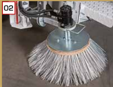
02 Tellerbesen zur Reinigung der Fahrbahndecke (optional)
