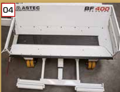
04 Hydraulisch ausfahrbare LKW-Andrückrollen
