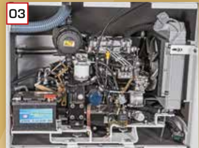
03 Leistungsstarker, wassergekühlter und geräuschreduzierter 3-Zylinder Kubota-Dieselmotor
