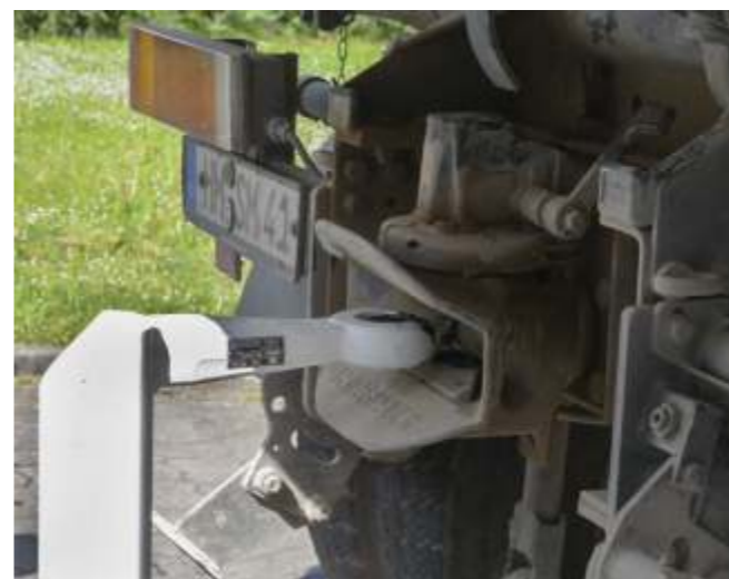
Einfaches Ankoppeln an den LKW
